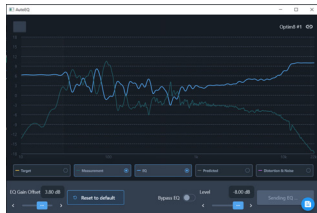
図 10 - ブーストが多すぎるイコライザーゲインオフセットを示すチューニング画面 イコライザー曲線全体が測定曲線の上にあります。
