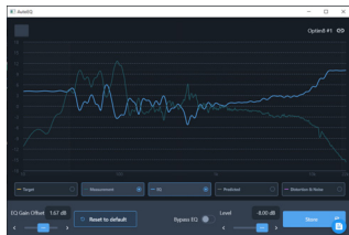
図 11 - 良好なイコライザーゲインオフセットを示すチューニング画面 カットとブーストのバランスが取れています。
