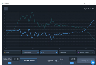
図 9 - カットが多すぎるイコライザーゲインオフセットを示すチューニング画面 イコライザー曲線全体が測定曲線の下にあります。
