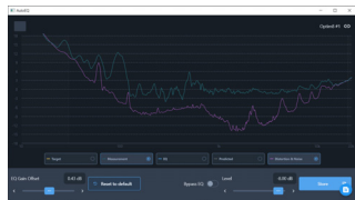
図 7 - 許容範囲外の多くのノイズを示すチューニング画面
