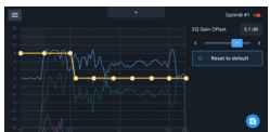
図 8 - ブーストが多すぎるイコライザーゲインオフセットを示すチューニング画面 イコライザー曲線全体が測定曲線の上にあります。
