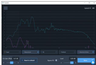
図 8 - 測定曲線よりも低い良好なノイズレベルを示すチューニング画面
