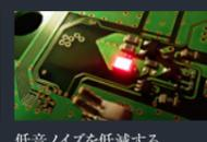
低音ノイズを低減する「赤色LED高音質電源回路」
