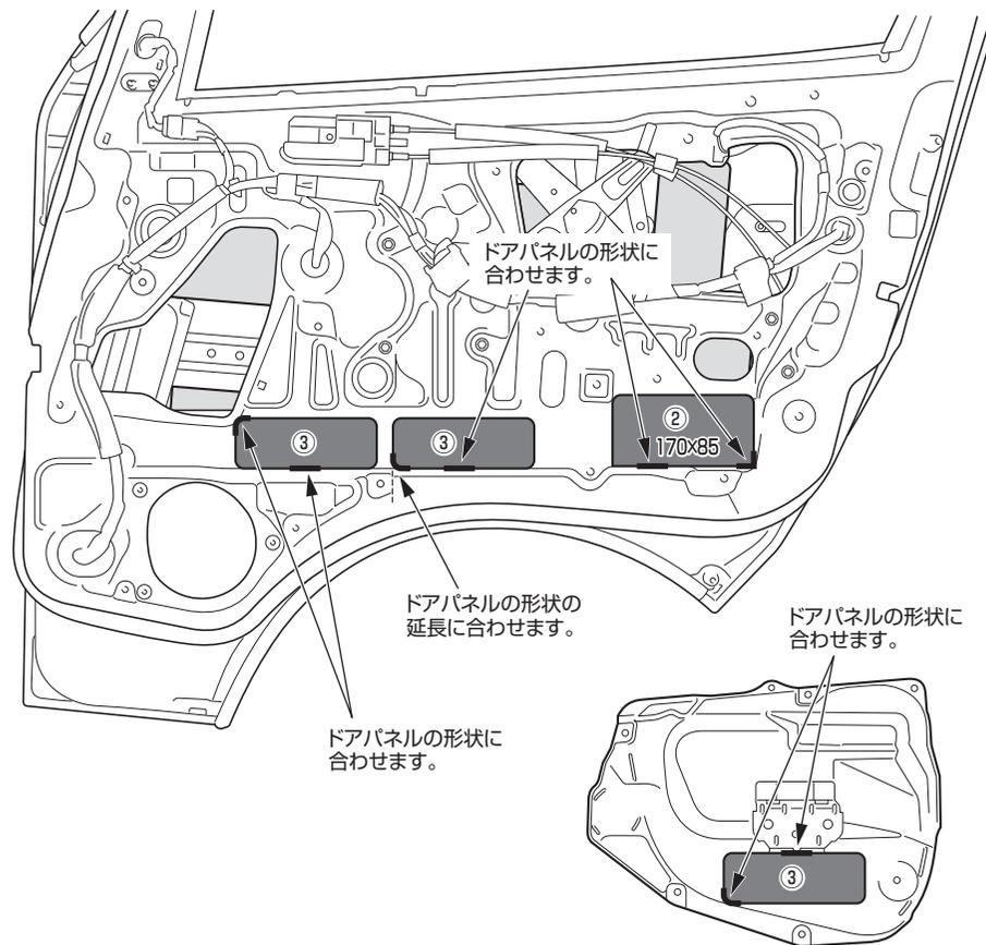
3) 下図を参照してフロントドアトリムにデッドニングシートを貼り付けます。
