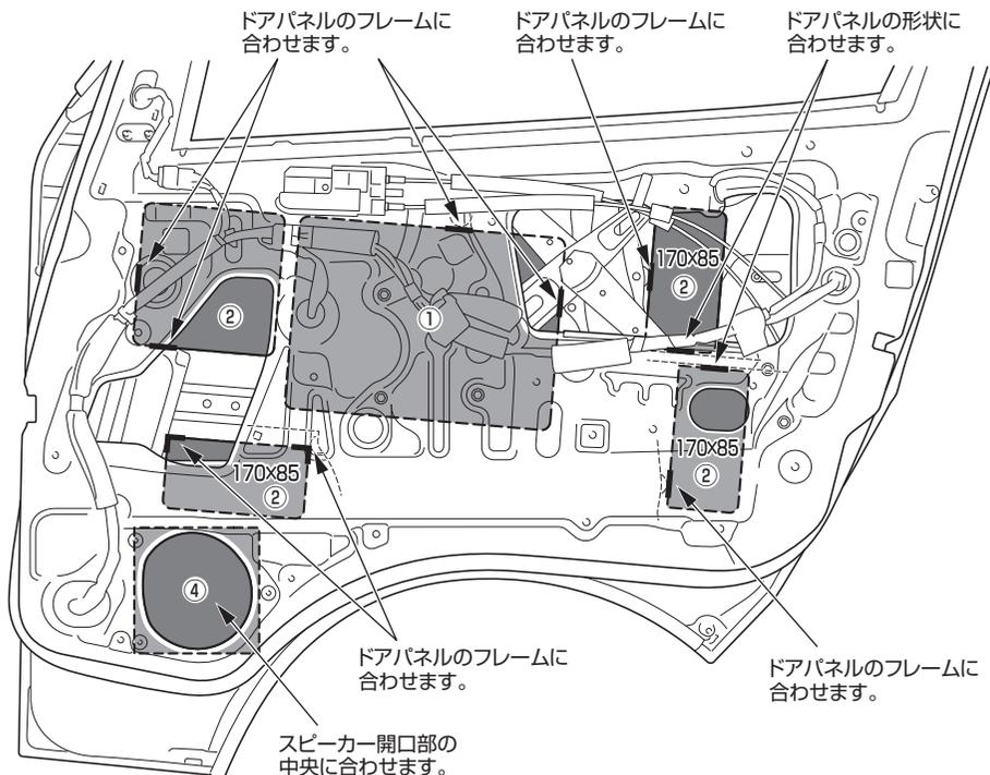
2) 下図を参照してフロントドアパネル表側の鉄板にデッドニングシートを貼り付けます。
