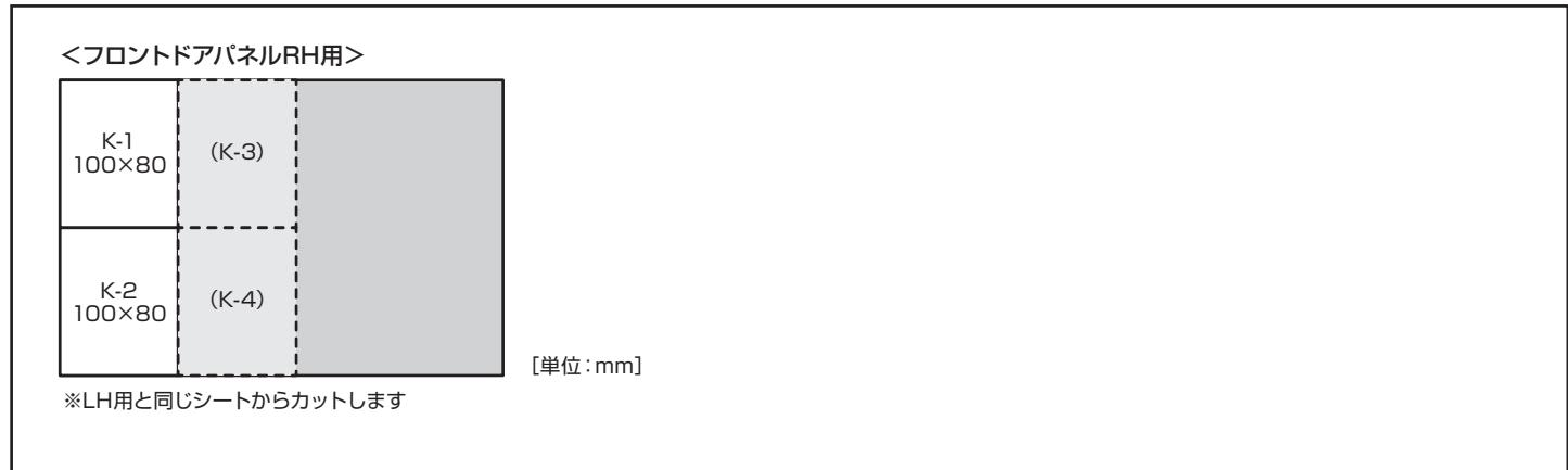
3. 下図を参考してフロントドアパネルRHに①静粛性向上シートを貼り付けます。
