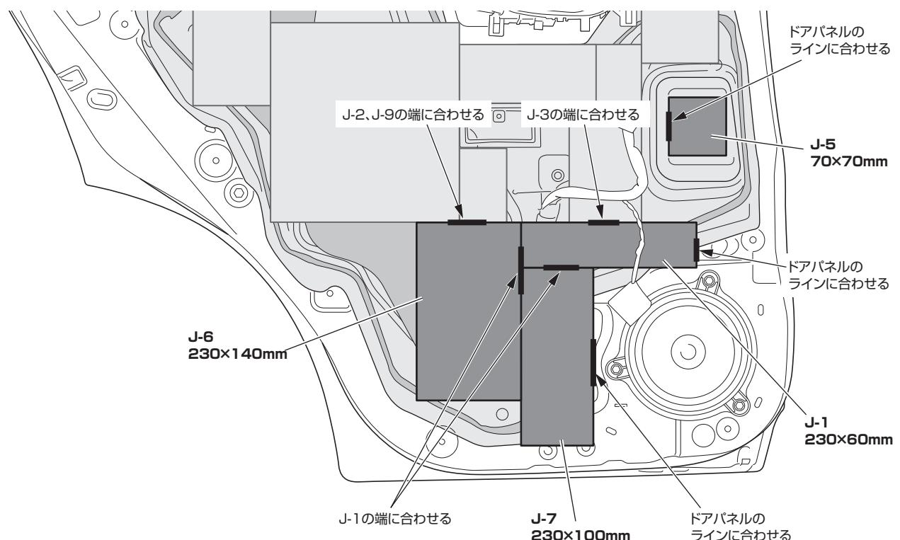
4. 下図を参照してリアドアパネルLHに②吸音シートを貼り付けます。
