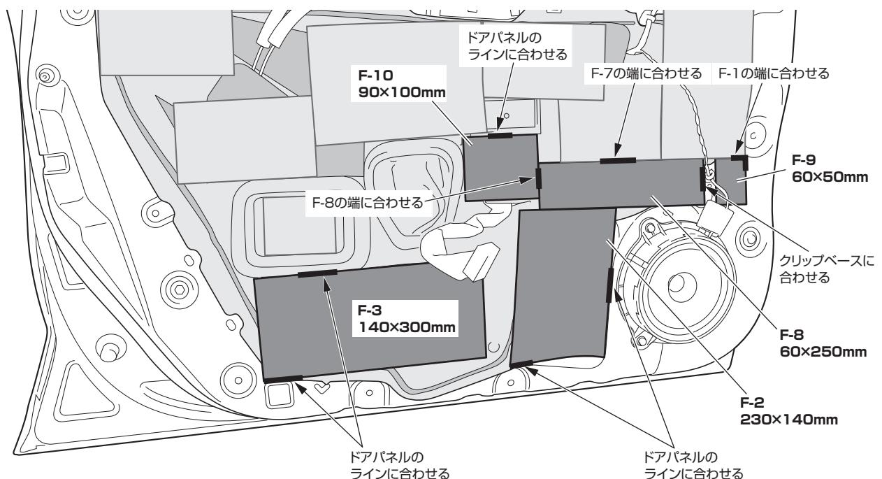
4. 下図を参照してフロントドアパネルLHに②吸音シートを貼り付けます。
