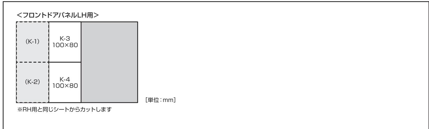
3. 下図を参考してフロントドアパネルLHに①静謐性向上シートを貼り付けます。
