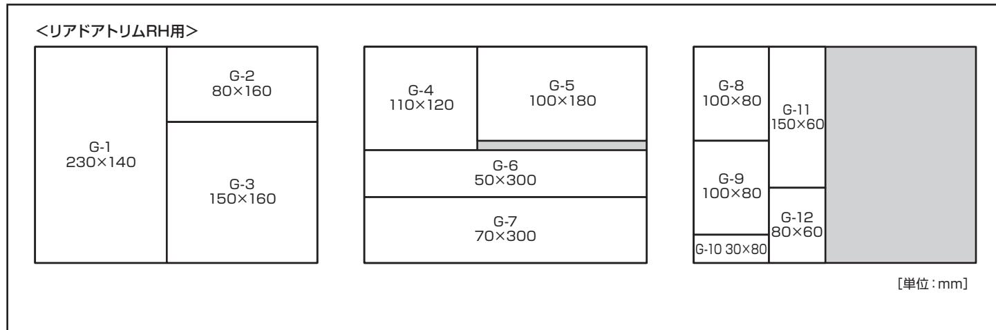
2. 下図を参考してリアドアトリムR/Hに①静肃性向上シートを貼り付けます。
