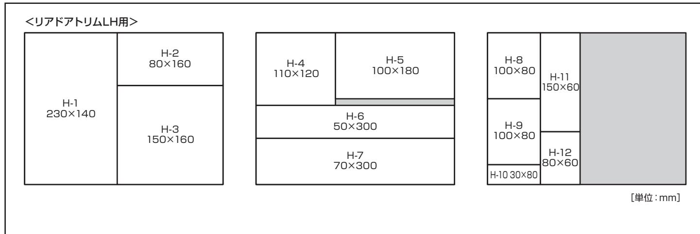
2. 下図を参考してリアドアトリムLHに①静謐性向上シートを貼り付けます。
