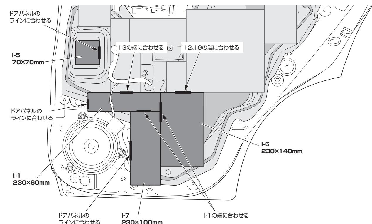
4. 下図を参考してリアドアパネルRHに②吸音シートを貼り付けます。
