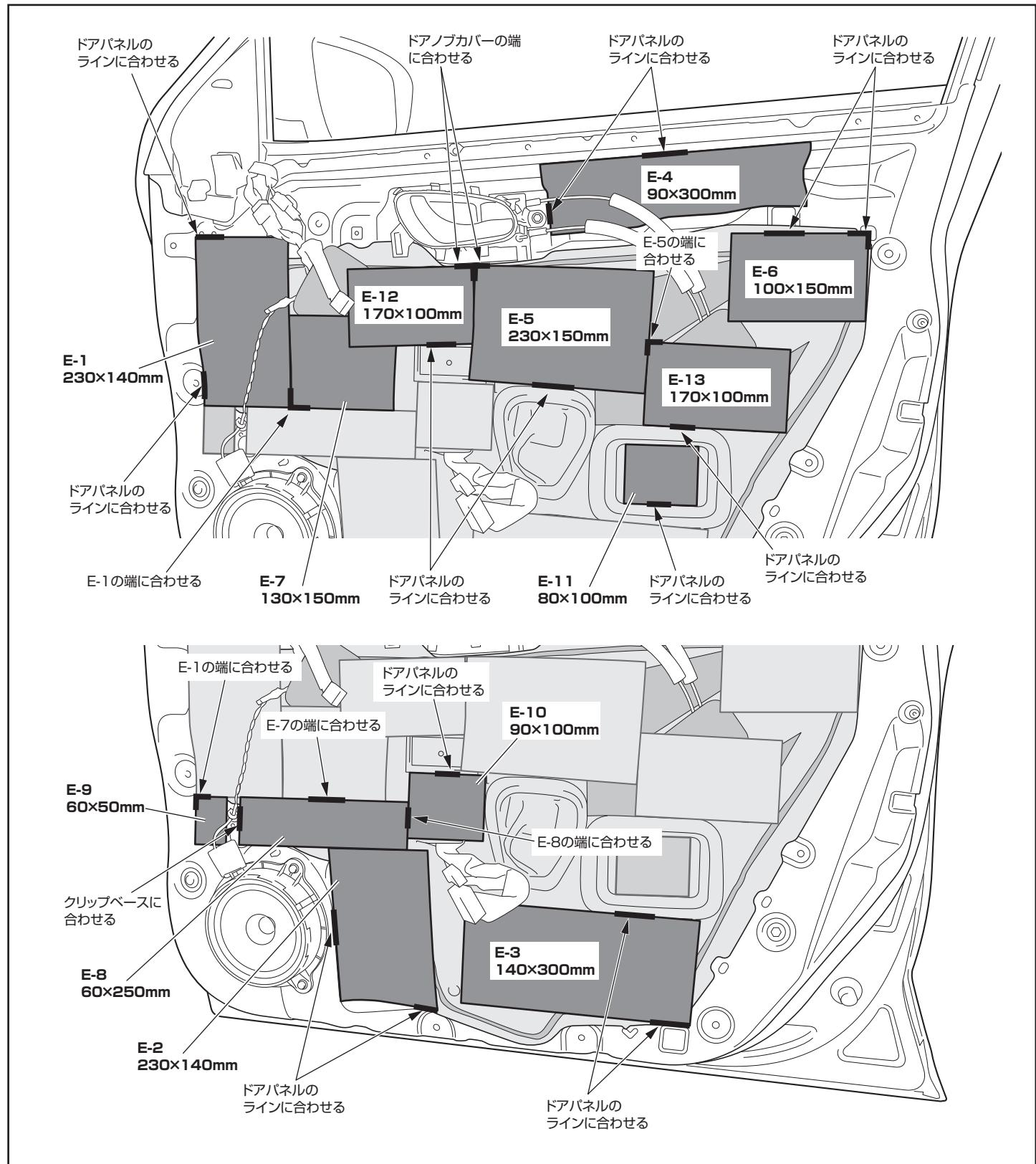
4. 下図を参照してフロントドアパネルRHに②吸音シートを貼り付けます。
