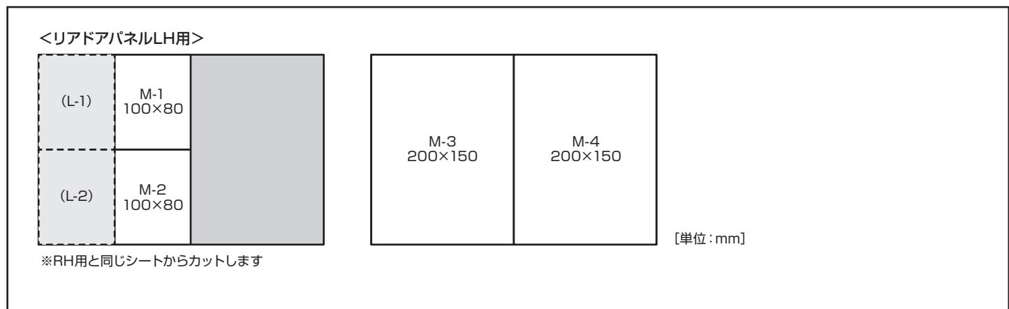
3. 下図を参考してリアドアパネルLHに①静謐性向上シートを貼り付けます。
