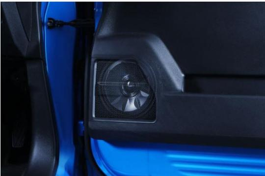
16.5cm の専用ドアウーファー (装着用バッフルボードまたはスパーサー付属) は、車室内スペースを犠牲にすることなく重低音再生を実現。ルーフスピーカーから降り注ぐクリアな中高域と合わせて、車室内が楽しく迫力のあるサウンド空間に生まれ変わります。
