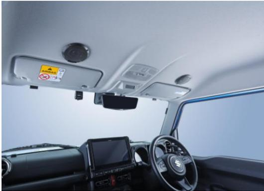
MetioSound (メティオサウンド) は、車両の天井部分に 5cm のルーフスピーカーを装着することで、上方からサウンドが降り注ぎ、まるでライブ会場にいるかのような臨場感を生み出します。耳に近い位置から音が届くため、ロードノイズの影響を受けにくく、クリアでダイレクトに中高音域を楽しむことができます。ドライブ中によくある「走っているときに音楽が聴こえない」という悩みが解消され、快適なドライブが楽しめます。
